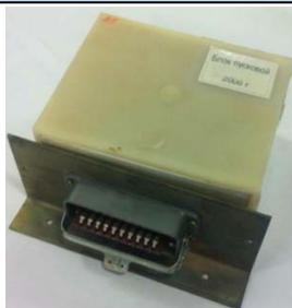
Предназначен для комплектации пускателя типа ПВИ-630МВ. Выполняет функцию форсированного включения и отключения контактора, путем кратковременной подачи повышенного напряжения на обмотки контактора и последующего удержания его во включенном состоянии на пониженном напряжении.
