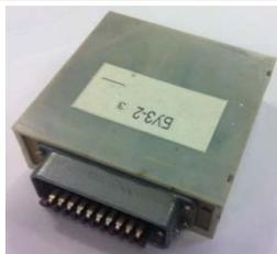
Предназначен для комплектации пускателя типа ПВИ-630МВ. Выполняет функции управления пускателем и токовых защит и блокировок для одного присоединения. Обеспечивает функционирование пускателя в режиме управления и защиты, настройки и просмотра технологической информации. Воспринимает команды от блока БДУ-Т, контролирует сопротивление изоляции отходящего присоединения. Причины аварийных отключений пускателя хранятся в энергонезависимой памяти.
