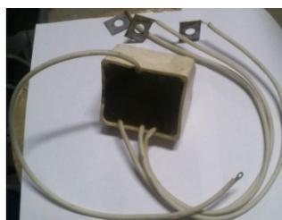
Предназначен для подключения устройства контроля изоляции к отходящей линии питающей сети в автоматических выключателях АВВ-400/250PM, АВВ-630PM-3, АВВ-400/250ДОМ, АВВ-630ДОМ-3.
