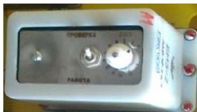
Электронные блоки типа БМЗ-2 предназначены для реализации защиты электрических сетей с изолированной нейтралью от токов короткого замыкания. Встраиваются в автоматические выключатели АВВ-400/250PM, АВВ-630PM-3, АВВ-400/250ДОМ, АВВ-630ДОМ-3.
